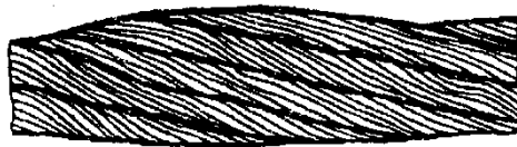
Рисунок 13. Местное увеличение диаметра каната
