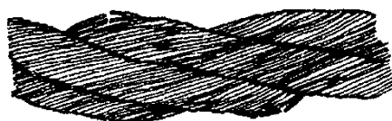
Рисунок 1. Обрывы и смещения проволок каната крестовой свивки
